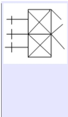
Porte à flot avec obturation de l'aval+ clapet surélevé + passe mesure amont (passage triple)
